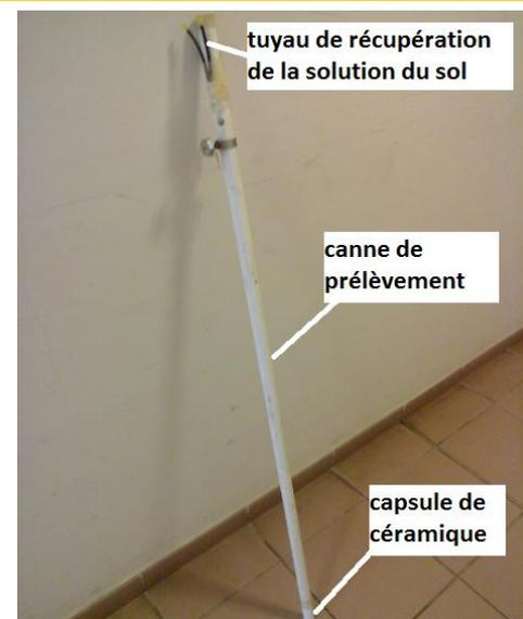
Photo 2 : Capteur de solution du sol.
